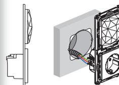
Montada numa caixa de encastrar simples com 40 mm de profundidade
